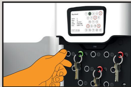
Grüne LEDs zeigen an, auf welche Schlüssel ein bestimmter Nutzer Zugriff hat. Der Nutzer kann Schlüssel mit roter LED-Anzeige nicht entnehmen. Diese bleiben weiterhin in ihren Steckplätzen verriegelt.
